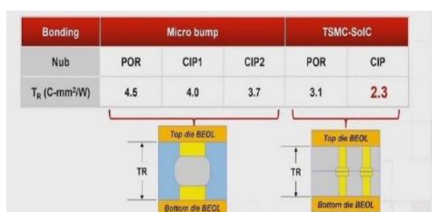
图表91: SoIC 具有更优异的热性能表现
