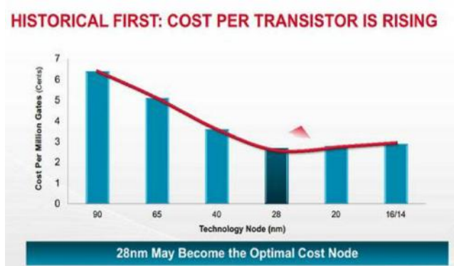
图表66： 每百万门晶体管的成本在 28nm 后开始上升
